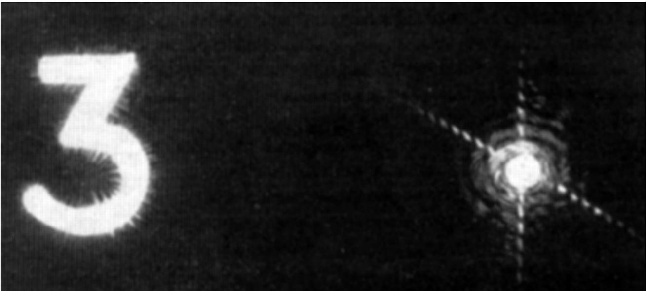
Фурье-спектр образа цифры «3», полученный оптическим способом
