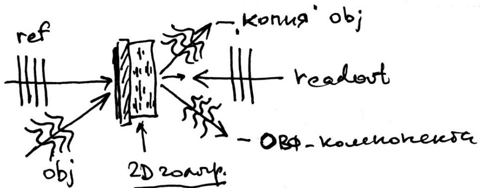
Компенсация фазовых искажений с использованием жидкокристаллического модулятора фазы:
