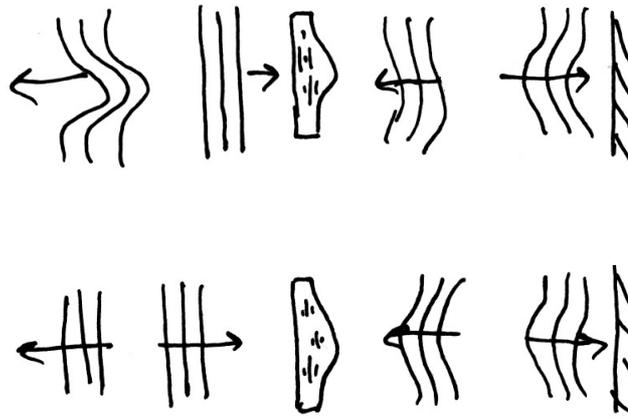
Обращение волнового фронта с использованием жидкокристаллического модулятора фазы:
